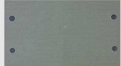
Ø0.15 Drill加工(x60 拡大) ジルコニア(ZrO 2 )
