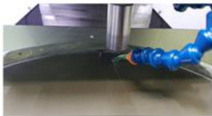
초음파(Ultrasonic) 스피들을 이용한 세라믹 Ø0.1 hole가공
